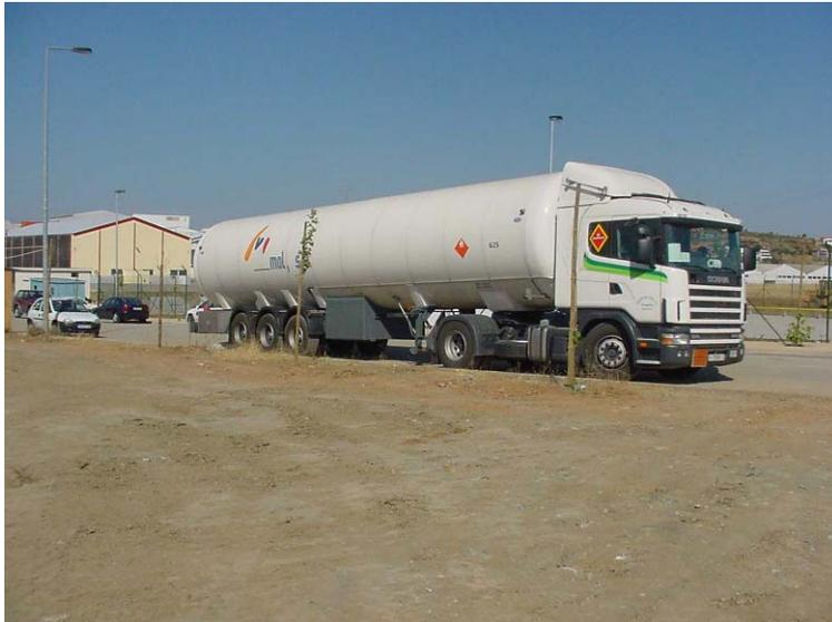
Fig. 2.53 – Cisterna de GNL (capacidade de 50.000litros)
